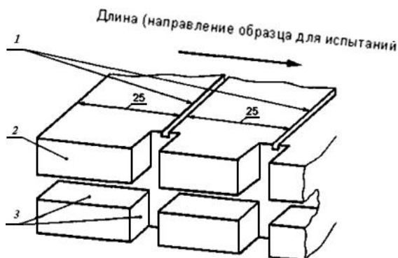
Рисунок 7.21 - Часть рамы U-образной формы; нижняя часть предусмотрена для натягивания проволоки
